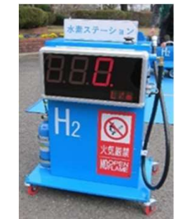
図3 水素供給装置(水素ステーション)
